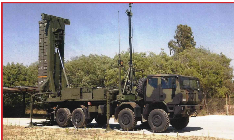
Il Modulo di Lancio (MLT) è armato con 8 missili ASTER 30 in altrettanti contenitori/lanciatori (nell'immagine se ne vedono solo 2)
